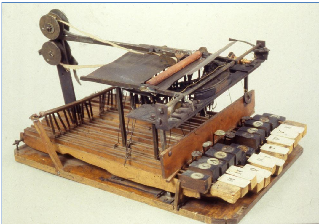
Una delle riproduzioni del “Cembalo Scrivano” di Ravizza. Come si può osservare, la macchina è realmente costruita similmente a uno strumento musicale.
